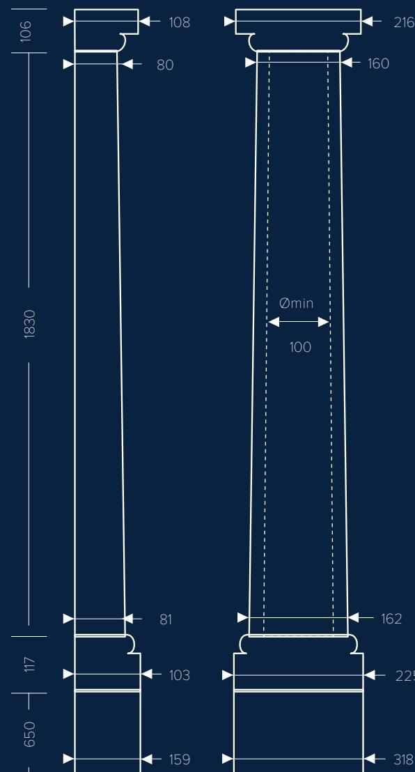
Габаритные размеры конструкции, мм.
