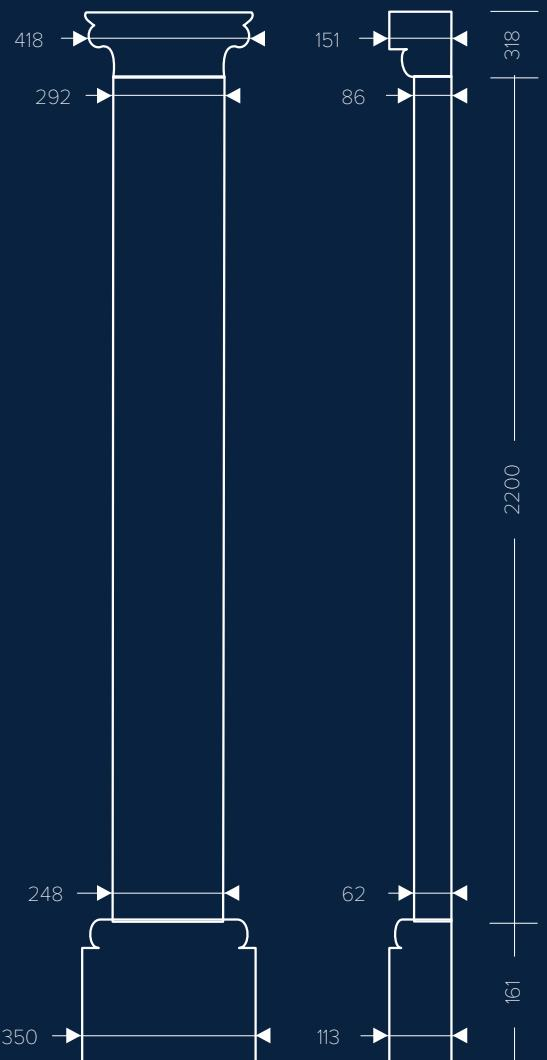
Габаритные размеры конструкции, мм.
