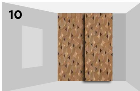
Устанавливаем следующие панели по заранее подобранныму варианту раппорта рисунка. При установке используем монтажный клей HD1000, а при монтаже на стены с деревянным покрытием или обрешеткой с помощью пневмопистолета и строительных шпилек.
