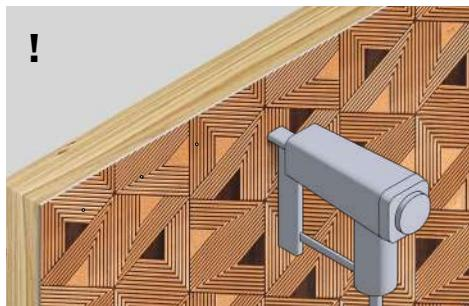
При монтаже на стены с деревянным покрытием или обрешеткой возможна установка с помощью пневмопистолета и строительных шпилек
