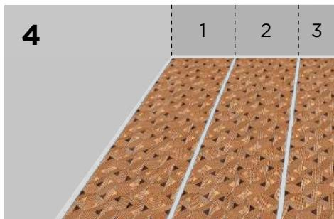
Разложите панели на полу вдоль стены на которую планируется монтаж для проверки правильности замеров.
