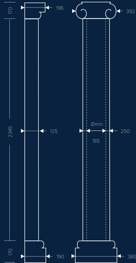
Габаритные размеры конструкции, мм.
