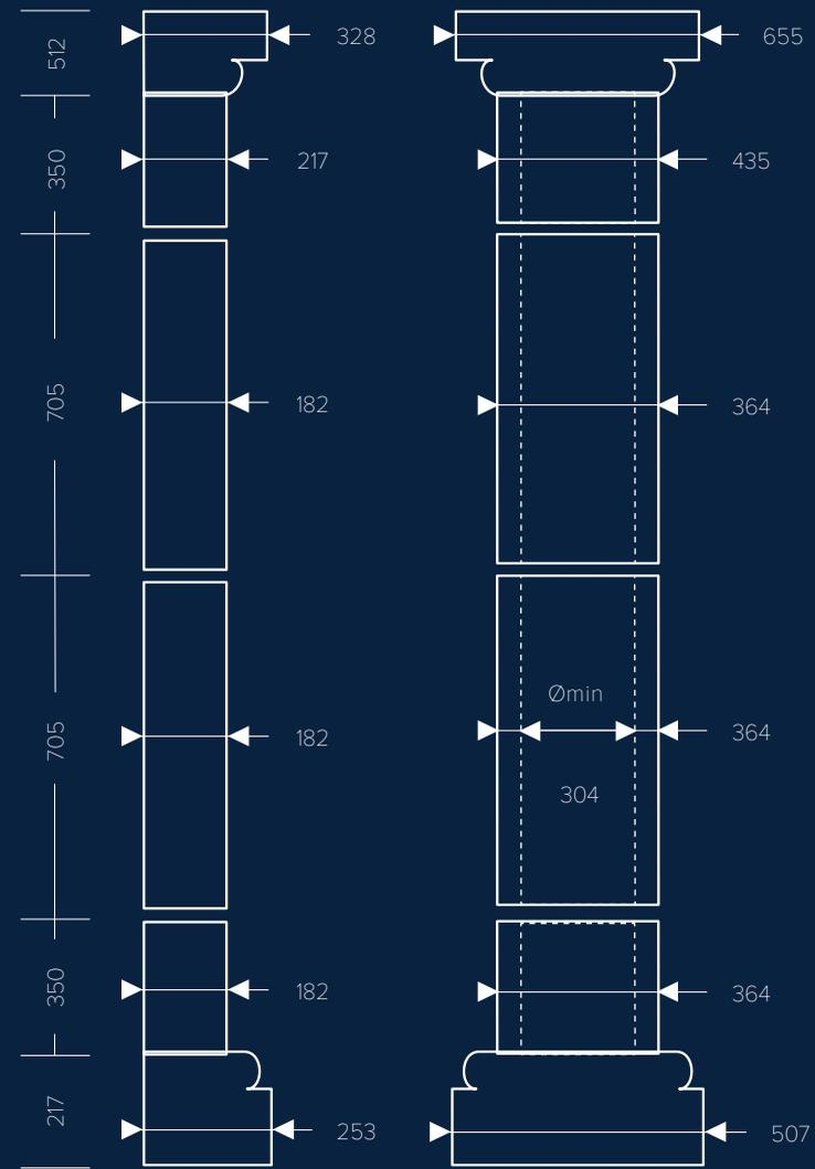
Габаритные размеры конструкции, мм.
