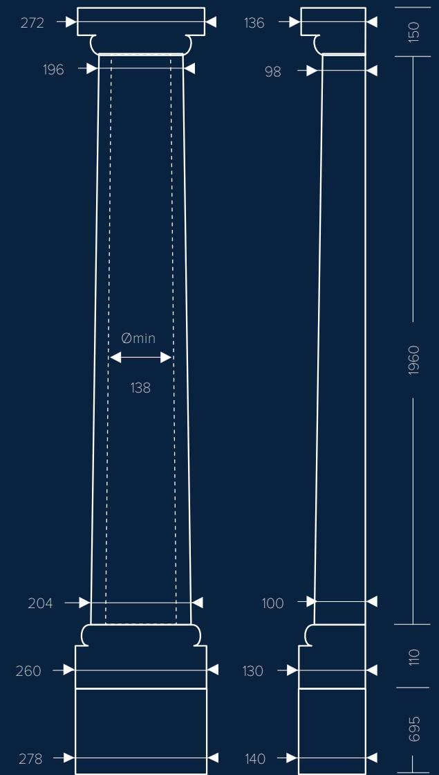
Габаритные размеры конструкции, мм.
